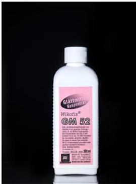
NBS Silikon darf nur mit dem Glättemittel für NBS Silikon verarbeitet werden. Seifenwasser (Spülmittel) darf in keinem Fall verwendet werden, da diese Art Produkte die Vernetzung im Silikon beschädigt – *auch wenn dies bei anderen Silikonen angegeben wird*. Die Fuge besitzt dann nicht mehr die überragenden Eigenschaften und altert deutlich schneller.
