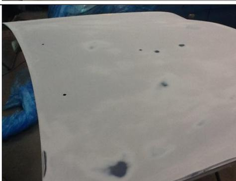
Diese Motorhaube wird mit einer Schicht **Invento-1-K-Primer UGR** gespritzt
